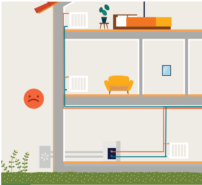
Étape 1 Remplacement de la pompe à chaleur, avec fixation du module extérieur contre le mur de façade
