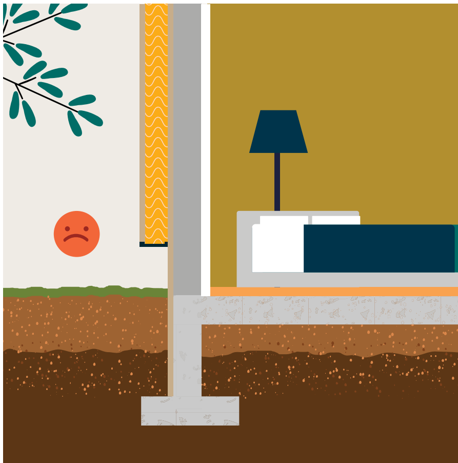
Étape 1 Isolation des murs par l'extérieur
