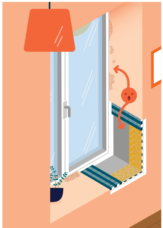
Étape 2 Remplacer les menuiseries extérieures posées en tunnel
